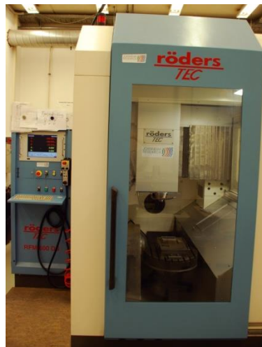
Kombinierte Laser- und Frässtation (Prototyp seit 2004)
